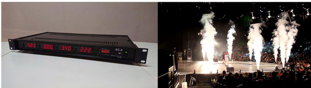
開発した理由は、CO2を噴射する演出を行う場合、スイッチとCO2ガスボンベからの噴射機器をDMX信号でつなぎ、噴射を制御しています。ガスボンベは重い上に中が見えないため、消費量が解りづらく、演出途中でのガス切れを防ぐことが課題でした。そのため演出時間を大まかに想定し、早めにボンベ交換をしていました。しかし、お客様からのお問合せを機に、正確な消費量がわかるカウンターを開発しました。
